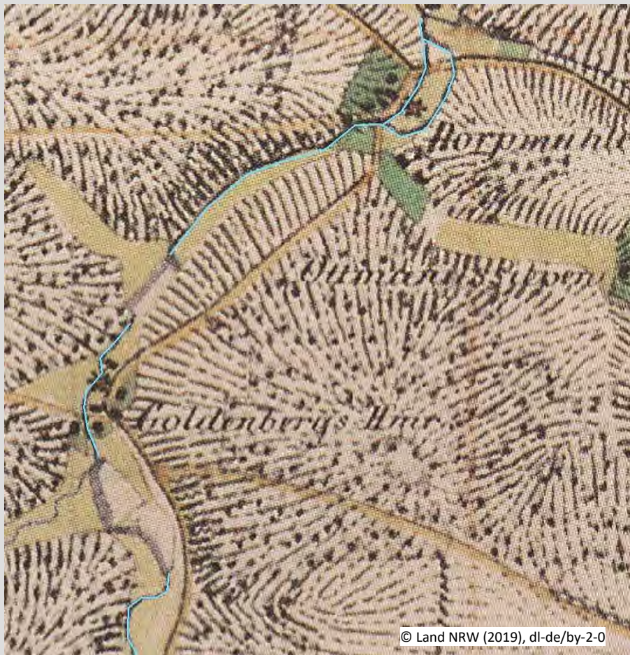
Abbildung 3: Uraufnahme 1842 – Dörpe: Dörpmühle/Goldenbergshammer, Wasserkraftnutzung mit zwei Teichen im Hauptschluss
